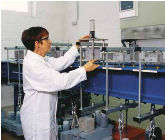
Abb. 11: Test des Kriechverhaltens im Speziallabor von Ravago
