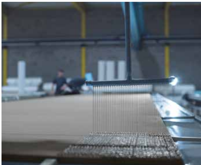
Abb. 16: Auftragen eines Zweikomponentenklebers (2K PU)
