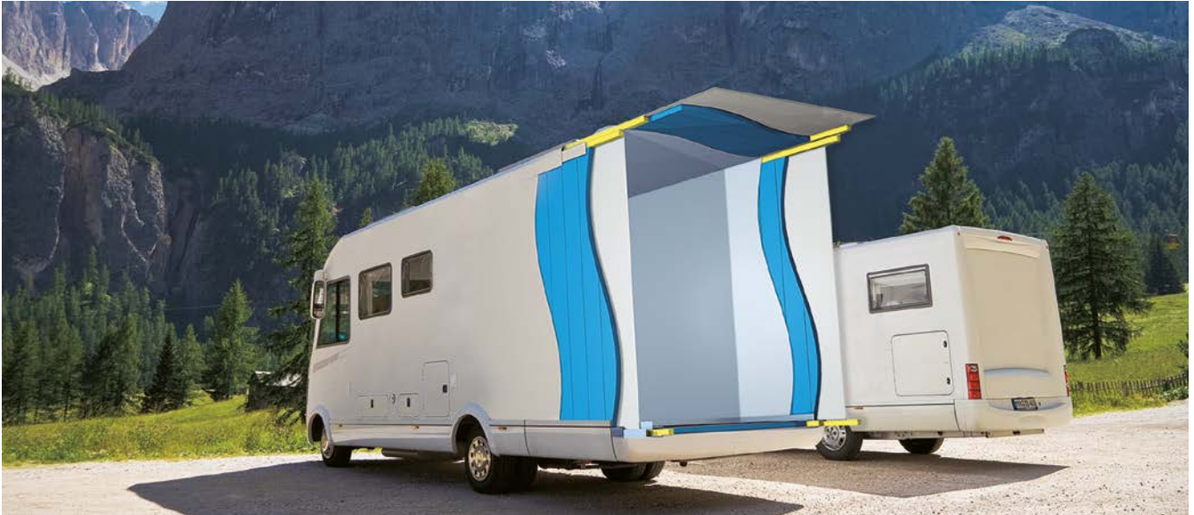
Sezione camper (vista semplificata di pareti e tetto che illustra l'uso di RAVATHERM™ XPS)
