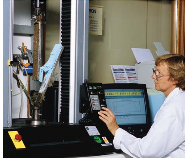
Fig. 08: Prova di taglio nel laboratorio di Ravago
