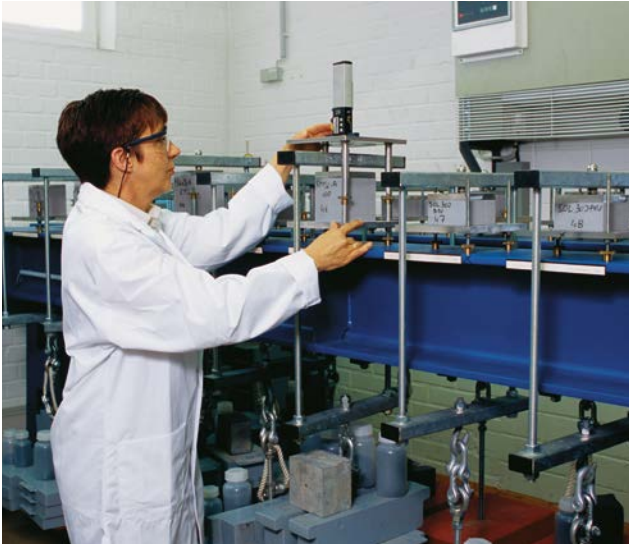
Fig. 07: Test delle prestazioni di scorrimento viscoso nel laboratorio di Ravago
