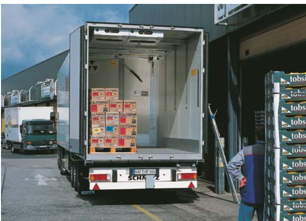
Fig. 11: Ben isolato e in grado di supportare carichi: carrozzerie di camion refrigerati con pannelli centrali RAVATHERM™ XPS.
