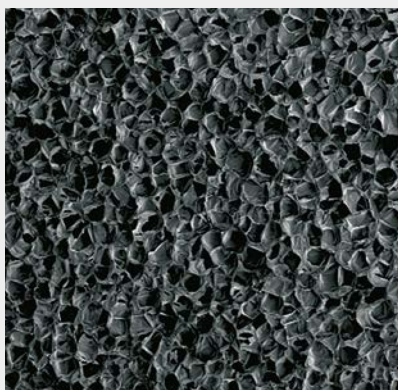
Struttura delle celle prodotto XPS
