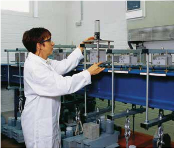
Abb. 11: Test des Kriechverhaltens im Speziallabor von Ravago
