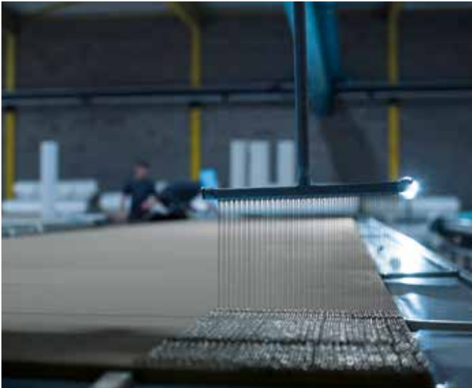
Abb. 16: Auftragen eines Zweikomponentenklebers (2K PU)
