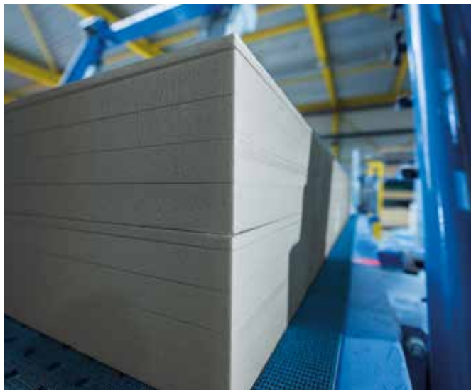
Abb. 14: Oszillierende Heißdrahtschneideanlage beim Stärkenschnitt
