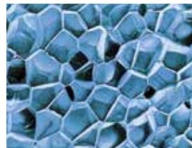
Anhand dieser Darstellung lässt sich erkennen, dass RAVATHERM™ mit seiner geschlossenen Zellstruktur sehr wenig Wasser aufnimmt. Dadurch weist RAVATHERM™ lediglich eine geringe Veränderung seiner Wärmeleitfähigkeit nach dem Wasseraufnahmetest auf.
