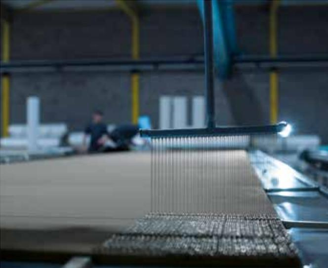
Abb. 16: Auftragen eines Zweikomponentenklebers (2K PU)
