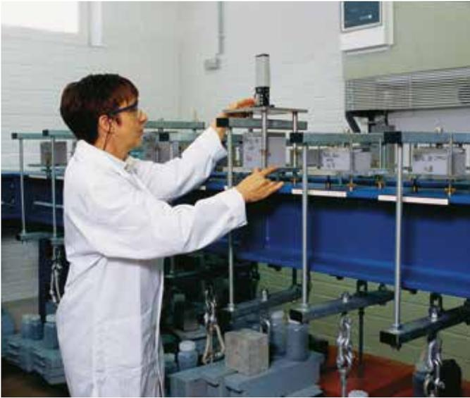
Abb. 11: Test des Kriechverhaltens im Speziallabor von Ravago
