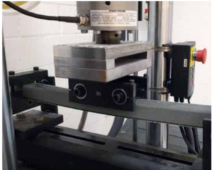
Abb. 13: Dynamischer Test an Sandwichplatten mit RAVATHERM™ XPS X Kern
