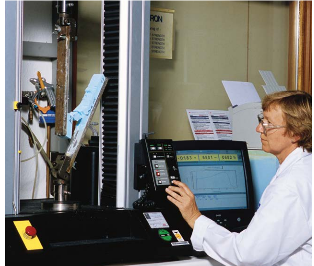
Fig. 08 : Essai de cisaillement dans le laboratoire dédié de Ravago
