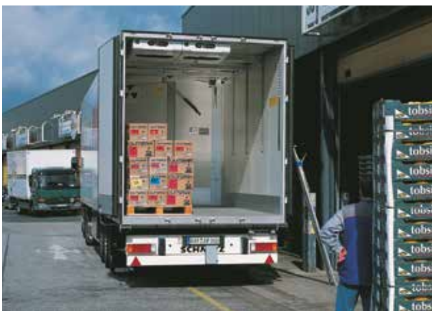
Abb. 11: Gut isoliert und tragfähig: Kühlnutzfahrzeuge mit RAVATHERM™ XPS Kernplatten.
