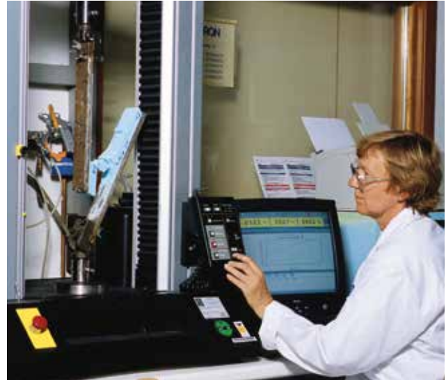
Abb. 08: Eine Ravago-Mitarbeiterin prüft das Scherverhalten unserer Dämmstoffe.
