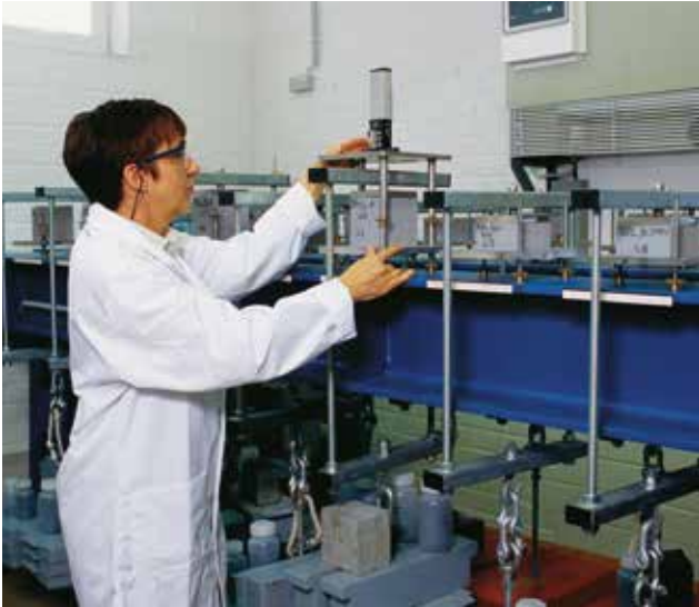
Abb. 07: Eine Mitarbeiterin testet im spezialisierten Prüflabor das Kriechverhalten unserer Dämmstoffe.
