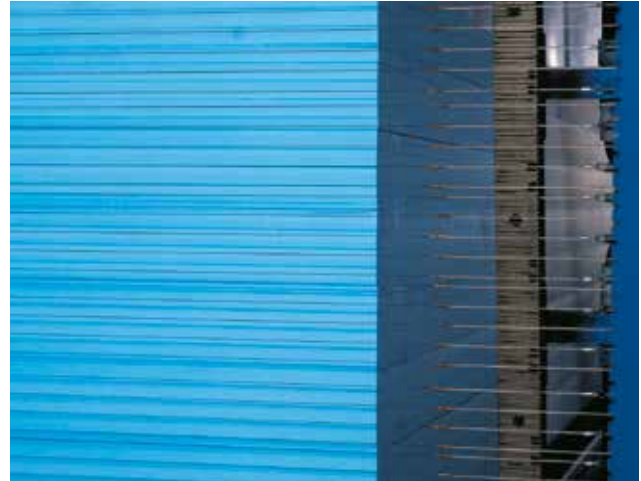
Abb. 09: Schneiden von RAVATHERM XPS mit einer Heißdrahtmaschine
