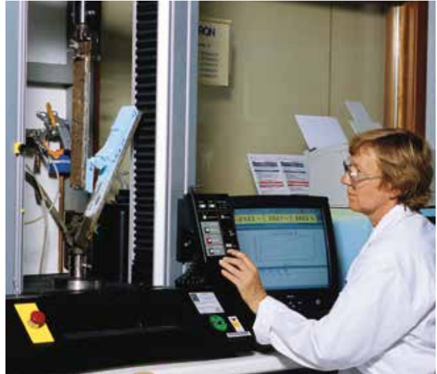
Abb. 08: Eine Ravago-Mitarbeiterin prüft das Scherverhalten unserer Dämmstoffe.
